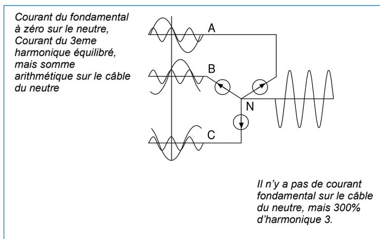
Figure 5: Circulation de courant harmonique multiple de 3
